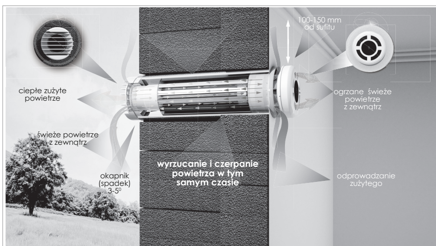
Rys. 1. Zasada działania rekuperatora PRANA-150, PRANA-200C, PRANA-200G
