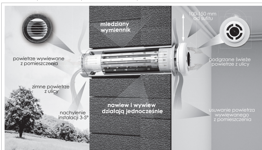
Rys. 1 Zasada działania rekuperatora PRANA-150 Stop Smog, PRANA-200C Stop Smog, PRANA-200G Stop Smog
