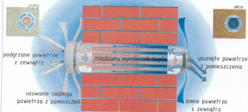
Rys.1 Zasada działania rekuperatora PRANA - materiał producenta.
